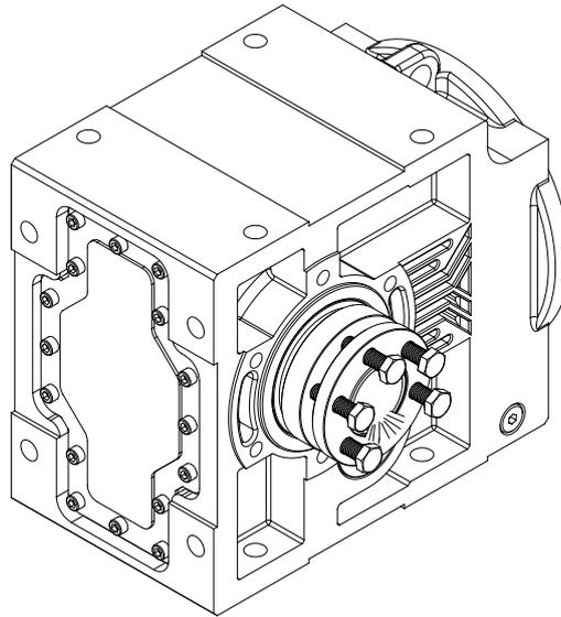
7.8.2- Verwende übliches Lösungsmittel zum Säubern von Öl und Schmutz auf der Welle und Schrumpfscheibe. Die Kontaktflächen sollen frei von Öl und Verschmutzung sein. Das Lösungsmittel soll auch von den Kontaktflächen entfernt werden.
