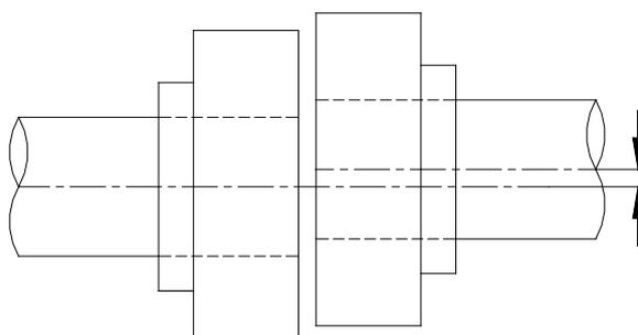
7.15.3- Bei der Kupplungsmontage die zulässige maximale Winkelverlängerung beachten. Diese ist aus den Daten des Kupplungsherstellers zu entnehmen.
