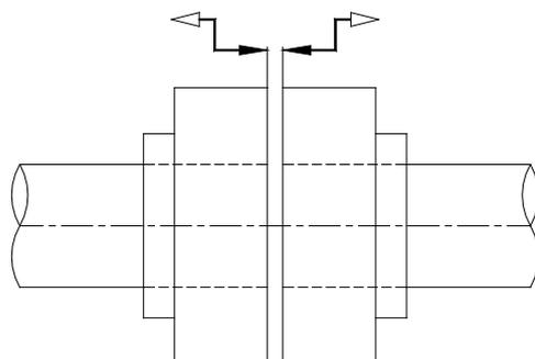
7.15.2- Bei der Kupplungsmontage den zulässigen maximalen axialen Versatz beachten. Dieser ist aus den Daten des Kupplungsherstellers zu entnehmen.
