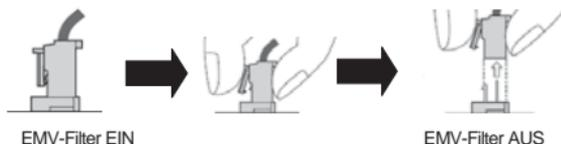
Prüfen Sie 10 Minuten nach Trennung der Spannungsversorgung die Spannung mit einem Spannungsprüfer. Um den Jumper zu entfernen, ziehen Sie den Jumper hoch, während Sie den Klemmhebel gedrückt halten (wenn er sich schwer abnehmen lässt, können Sie eine Pinzette oder Mikrozange verwenden). Wenn Sie den Jumper wieder adaptieren, achten Sie darauf den Klemmhebel des Jumpers einzurasten.
